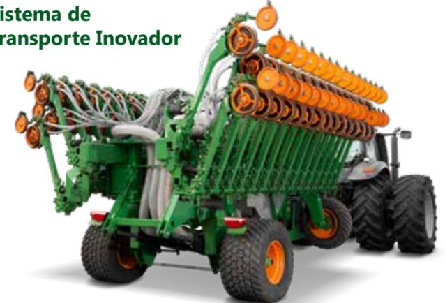
Guapa posee un exclusivo sistema de transporte, comandado por el Topper, deja la máquina con sólo 3,35 m de ancho entre las ruedas y 3,91 m de altura, facilitando el paso por carreteras o puentes estrechos.
