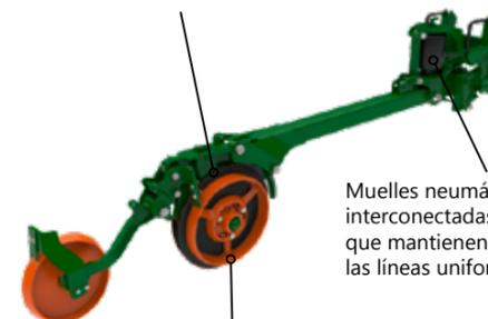
Limitador de profundidad de fácil cambio acoplada al cubo del disco doble.
